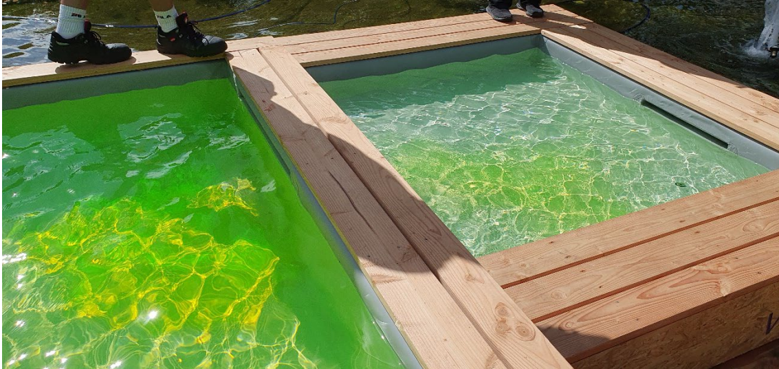
Abb. 6: Durchflusstest mit dem Färbemittel Uranin (Foto: Initiative Wärm Komp)
